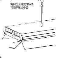
插入挡光板,用6角扳手扭紧螺丝。 可调节挡光板角度。
